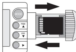
Pro přepnutí indikací naměřených hodnot stiskněte tlačítko „MODE“ (5) nebo tlačítko se šipkou „Dále“ (7). Každé stisknutí přepíná indikaci dále.
