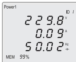
Maximální a minimální hodnoty ukládá měřicí přístroj do paměti automaticky. Prostřednictvím tlačítek „max“ (4) nebo „min“ (3) se tyto hodnoty na cca 10 sekund zobrazí na ukazateli. Dalším stiskem tlačítka dojde k předčasnému přepnutí zpět do normální indikace.
