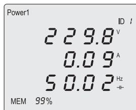
L'appareil de mesure enregistre automatiquement les valeurs maximales et minimales. Ces valeurs sont affichées pendant environ 10 sec. à l'aide des touches « max » (4) ou « min » (3). Un nouvel appui sur la touche permet de commuter plus tôt vers l'affichage normal.
