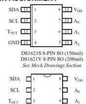
DS1621 8-PIN DIP (300mil) See Mech Drawings Section
