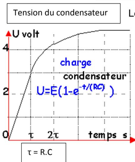
Les circuits électroniques du capteur vont mesurer le temps que met la tension du condensateur pour atteindre 3 V, ce
