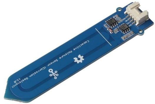
Le capteur Grove - Capteur d'humidité capacitif (résistant à la corrosion) est un capteur d'humidité du sol basé sur les changements de capacité. Par rapport aux capteurs résistifs, les capteurs capacitifs ne nécessitent pas d'exposition directe des électrodes métalliques, ce qui peut réduire considérablement l'érosion des électrodes. C'est pourquoi nous l'appelons **résistant à la corrosion**.
