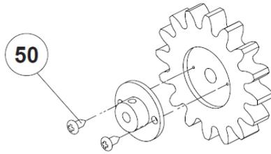
Fixer l'engrenage sur son support puis fixer l'ensemble sur l'axe du moteur.
