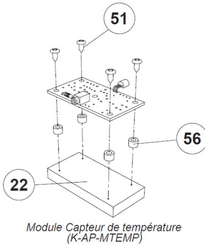
Module Capteur de température (K-AP-MTEMP)
